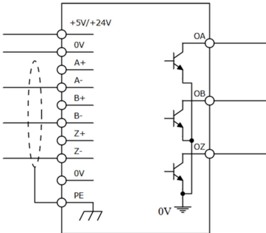
Рисунок 5 Схема подключения PD310PG1 (вход с открытым коллектором)
